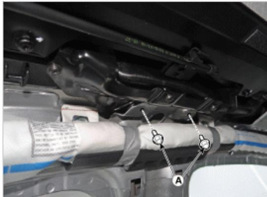
10. 安装窗帘式空气囊(CAB)总成。
