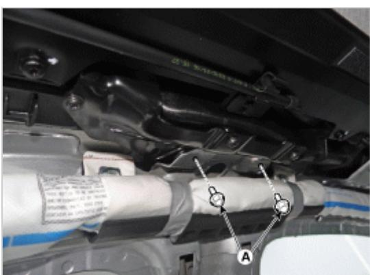
7. 向左右拉动方形丝(A), 按箭头方向施力切断天窗前端边角(B)的密封胶。
